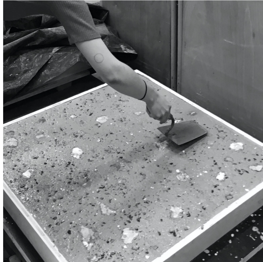
letzte Ausbesserungsarbeiten vor dem Trocknungsprozess
